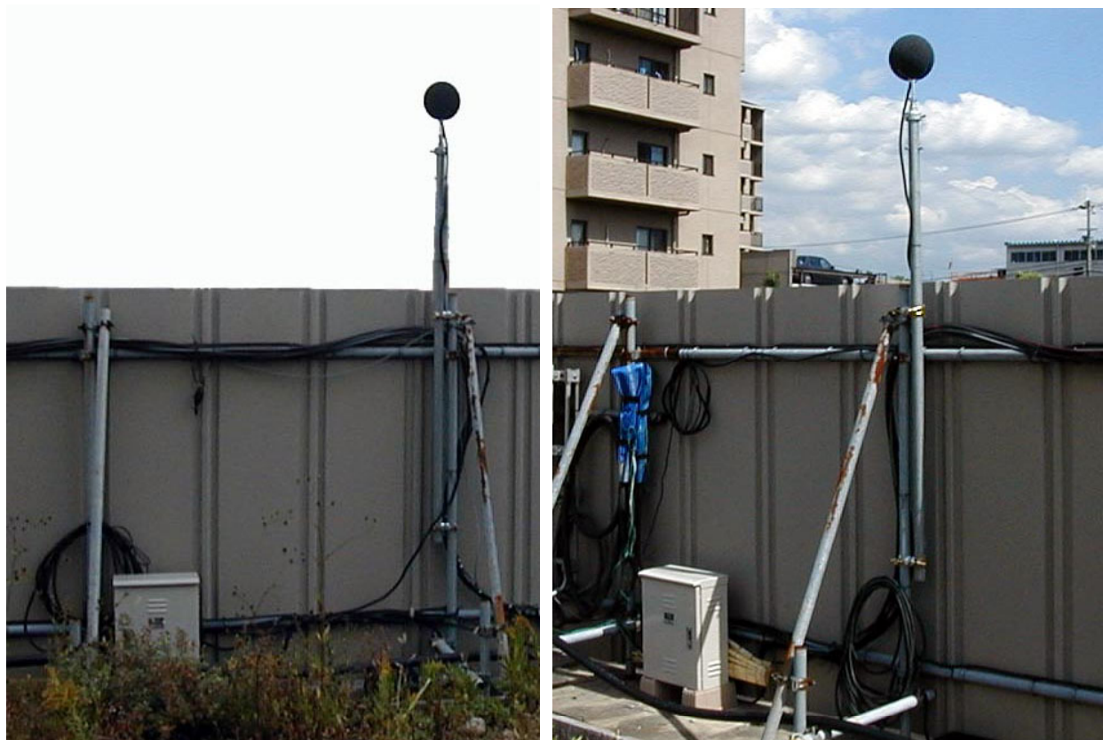
騒音振動システム設置写真（例）
